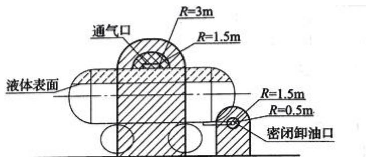
图 C.0.4 汽油的地面油罐、油罐车和密闭卸油口
