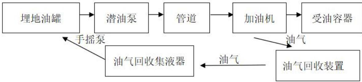
图 2.4-2 汽油加油工艺流程图
